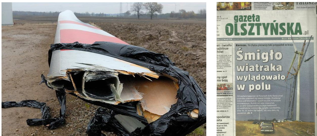
Rys. 9. Łopata na farmie w Korszach, z której urwała się 5.5 metrowa końcówka.
